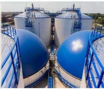
Промышленные реакторы с нагрузкой до 10 кг ОВ/м.куб
